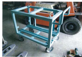
↓ 特注台車製作途中 骨組み
