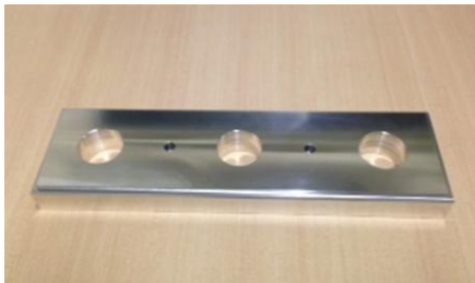
↓ 切削基準治具完成品 材質：アルミ
