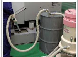
大量のクーラント液を200Lドラム缶に約1分50秒で回収します
